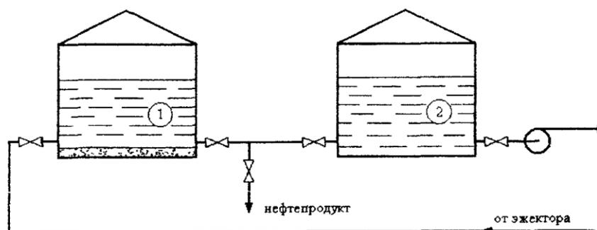
Рисунок 15 - Схема каскадного отстойника их двух РВС
