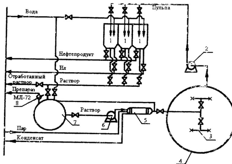
1 - отстойник; 2 - поршневой насос; 3 - моющая машинка; 4 - очищаемый резервуар;
