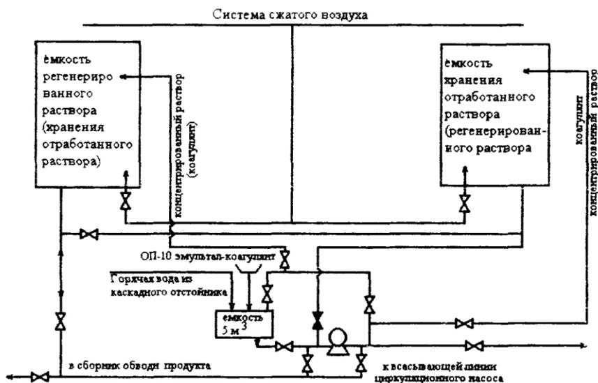
Рисунок 17 - Схема приготовления и регенерации моющего раствора ММ-5
