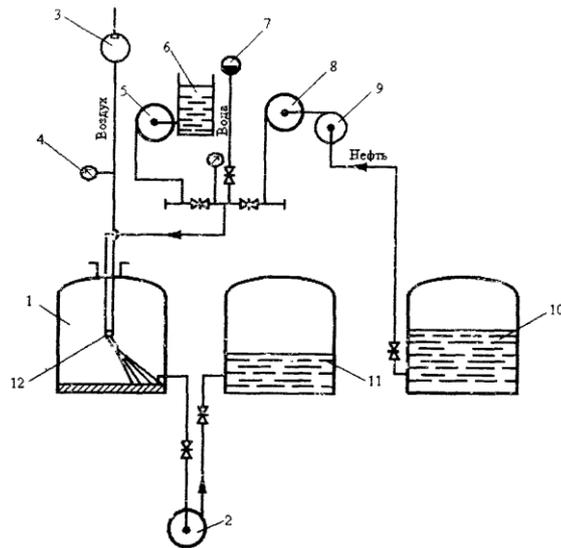
1 - очищаемый резервуар; 2 - откачивающий насос; 3 - компрессор; 4 - манометр;
