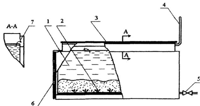
1 - корпус; 2 - перфорированные трубы; 3 - крышка корпуса; 4 - газоотводная труба; 5 - паропровод; 6 - сливная труба; 7 - сливные карманы
