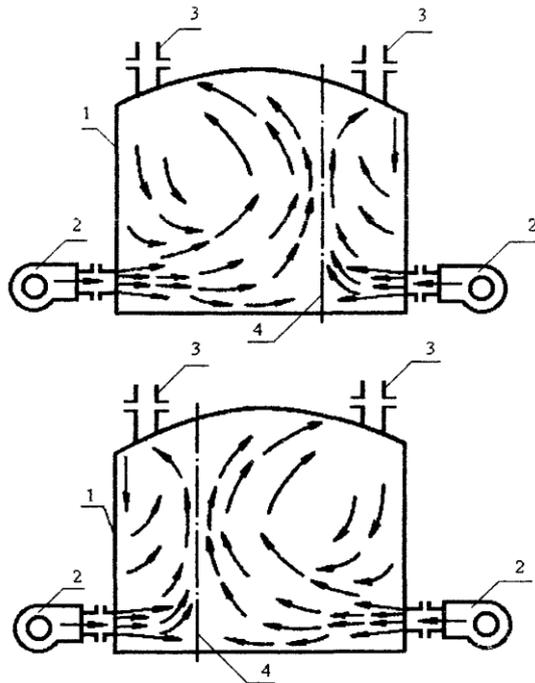
1 - резервуар; 2 - вентилятор; 3 - газоотводная труба; 4 - плоскость соударения струй
