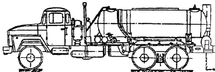
Рисунок 21 - Агрегат моечный для резервуаров АЗС (АМ-10)
