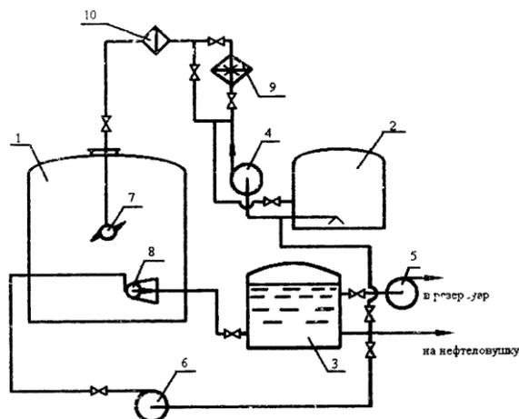
1 - очищаемый резервуар; 2 - емкость для ноющего раствора; 3 - резервуар-отстойник;
