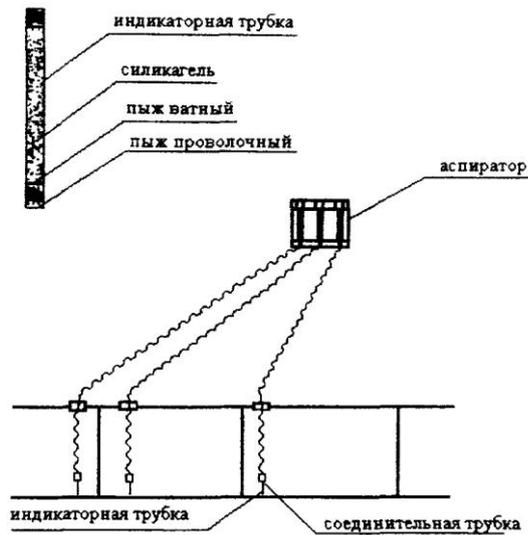
Рисунок 19 - Схема отбора пробы воздуха на содержание ТЭС
