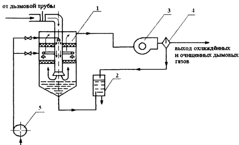
1 – скруббер; 2 - сливная воронка (гидрозатвор); 3 - вентилятор (дымосос);
