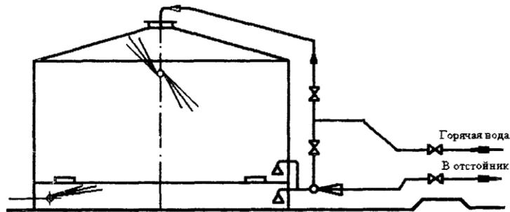
Рисунок 5 - Схема мойки резервуара с понтоном.
